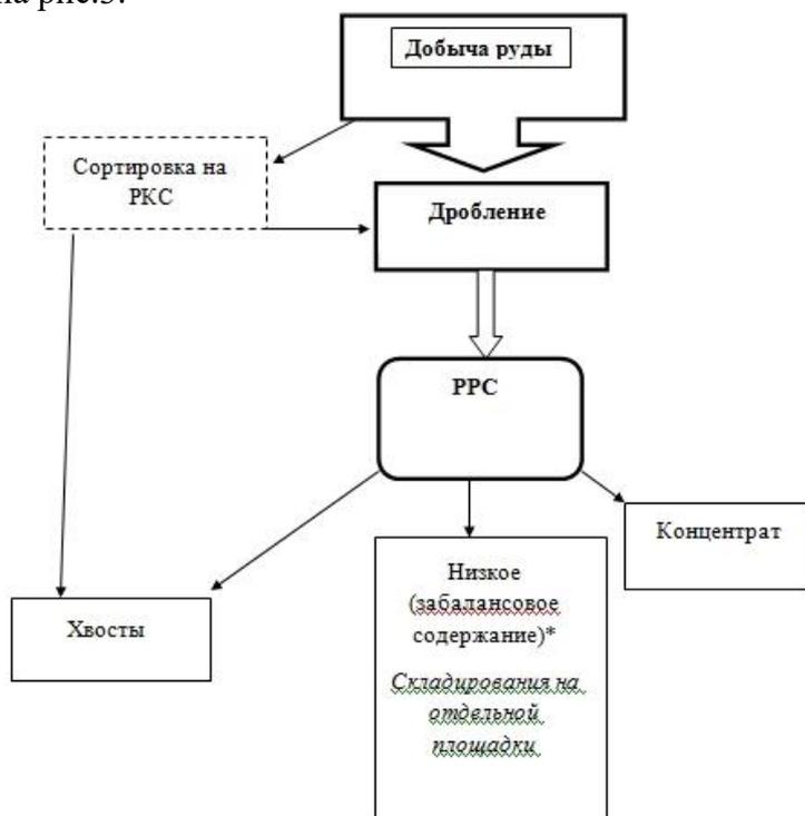
Рисунок.3 Предполагаемая технологическая схема обогащения руды методом РРС
