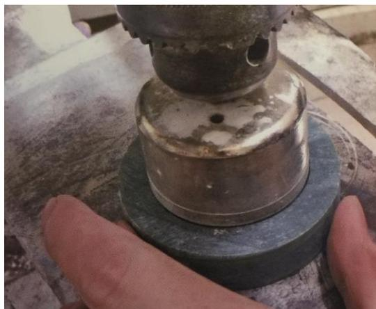
**Рисунок 8.** Высверлить центральную часть
