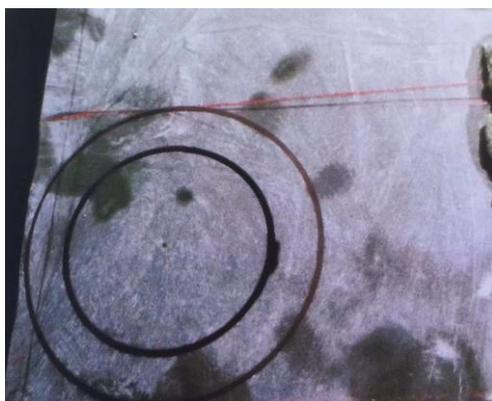
*Рисунок 3. Установка центрального положения, обозначение наружного и внутреннего колец браслета циркулем*
