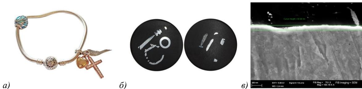
**Рисунок 1.** а - объект исследования - браслет с подвесками; б - шлифы в электропроводящей матрице; в - измерение толщины гальванического покрытия в микронах.
