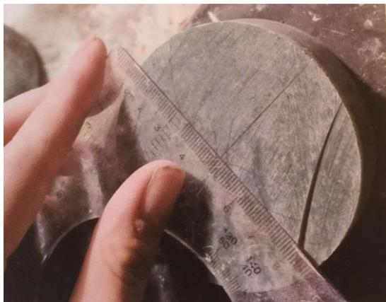
**Рисунок 5.** Необходимо измерить диаметр наружного кольца браслета линейкой
