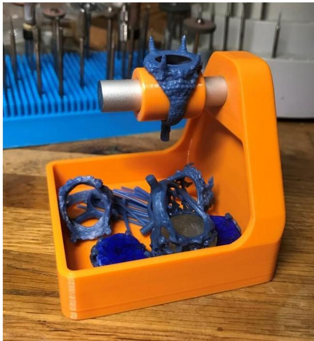
*Рисунок 3. Напечатанная подставка для моделирования колец в процессе использования*
