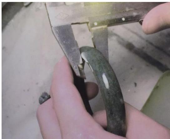
**Рисунок 11.** Проверить размеры отшлифованной заготовки браслета
