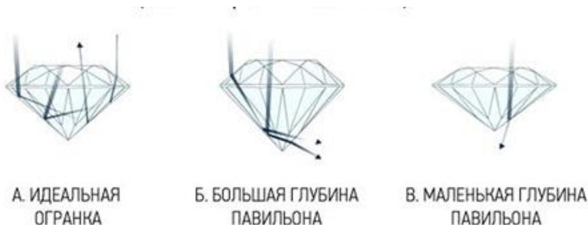
**Рисунок 1.** Зависимость формы конуса от распространения света внутри твердых материалов.
