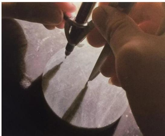
**Рисунок 7.** С помощью таких инструментов, как циркуль и эксцентрик нарисовать внутренний круг
