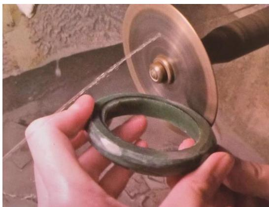
**Рисунок 9.** Сгладить внешние края заготовки браслета
